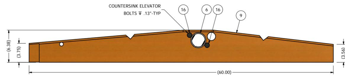
STEP 1: RIGHT ROCKER SIDE ASSEMBLY, LEFT SIDE VIEW
