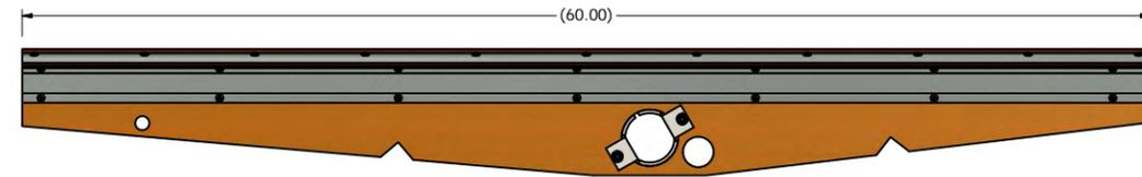
STEP 2: RIGHT ROCKER SIDE ASSEMBLY, LEFT SIDE VIEW
